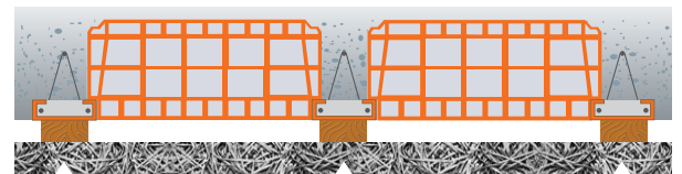
Solaio in laterocemento rivestito con pannelli Celenit fissati ad una listellatura in legno
