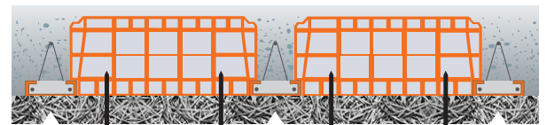
Solaio in laterocemento rivestito con pannelli Celenit fissati con tasselli ad espansione
