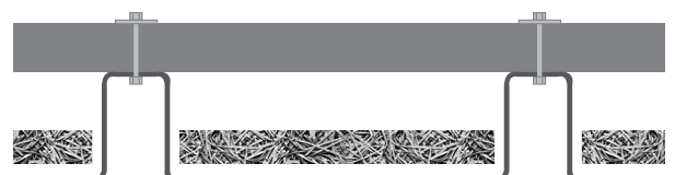
Isolamento termico ed acustico di coperture in carpenteria metallica
